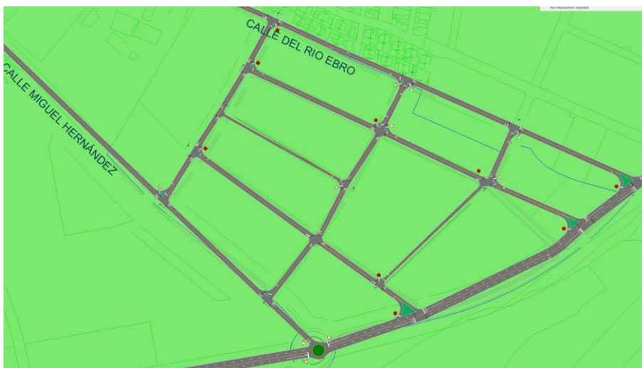
imágenes: Modelo de tráfico del sector realizado con la herramienta Syncro 11.
