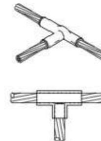
DETALLE SOLDADURA ALUMINOTÉRMICA TIPO II
