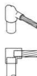
DETALLE SOLDADURA ALUMINOTÉRMICA TIPO V
