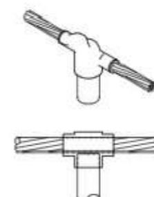
DETALLE SOLDADURA ALUMINOTÉRMICA TIPO VI
