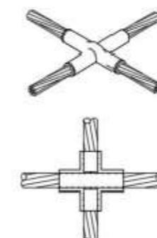
DETALLE SOLDADURA ALUMINOTÉRMICA TIPO III
